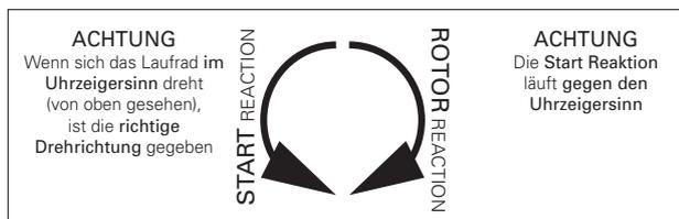
Bei großen Pumpen kann man die Drehrichtung auch erkennen, indem man durch den Druckstutzen in die Pumpenkammer schaut. Hier sieht man das Laufrad und kann nach einem kurzen einschalteten, beim auslaufen des Laufrades die Drehrichtung kontrollieren.
